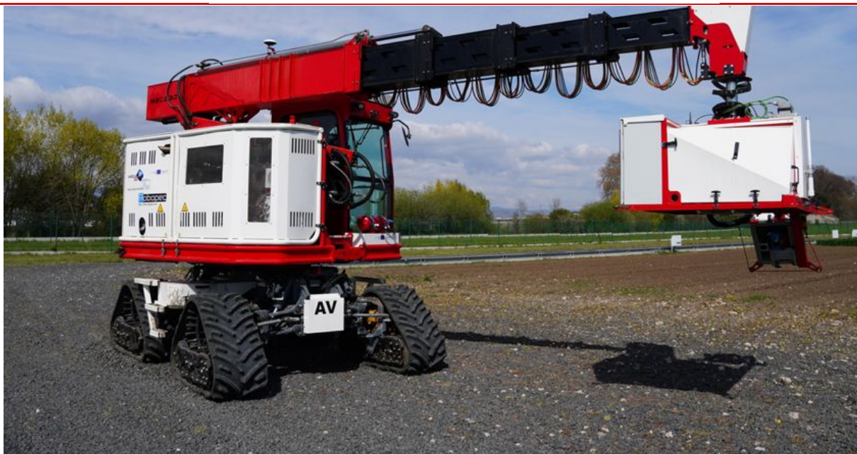
La PhénoMobile est un robot à déplacement autonome qui recueille des informations sur la parcelle grâce à l'imagerie. (© Clara Marie)
